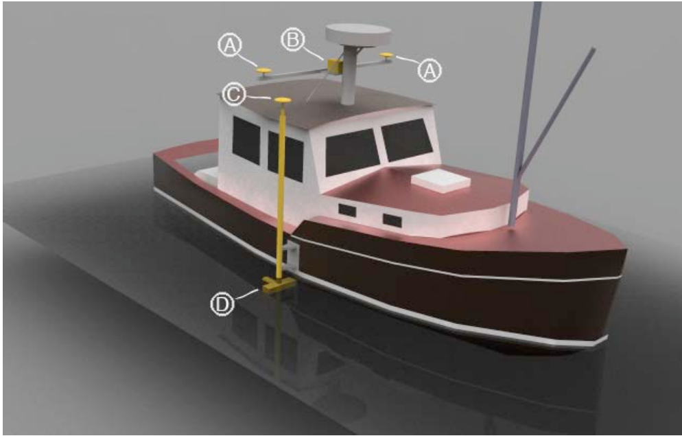
Fig 1 Illustration af opmålingsbåden med påmonteret måleudstyr. A: To stk GPS forbundet med B: Applanix motionsensor til angivelse af bådens retning og hastighed over grunden. Motionsensoren korrigerer desuden for roll, pitch og heave. C: GPS til positionering af D: Seabat 8125 multibeamsonar
