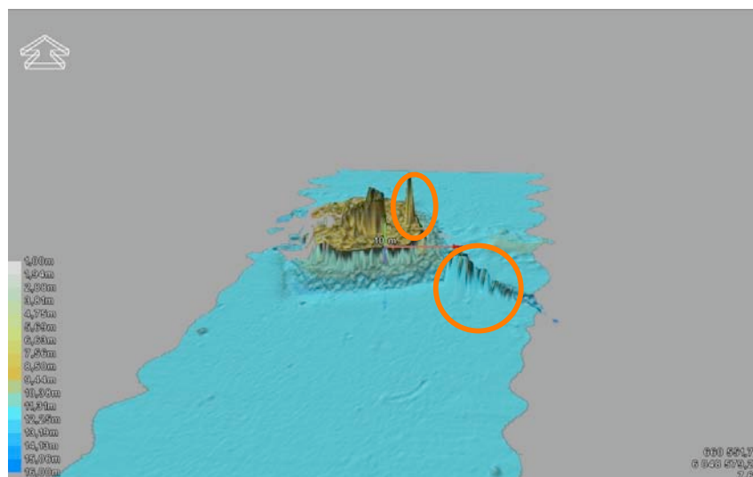
Fig 23 4.linie sejles. Her opdages fejlskud ved fundamentet. De optræder ikke på fig 20 og fig 21
