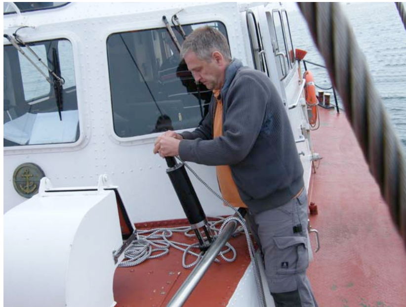
Fig 7 Opmåleren klargør lydhastighedsproben RESON SVP 15, som langsomt sænkes til bunden. Data om saltholdighed, temperatur, tryk og lydhastighed opsamles og lagres i proben.
